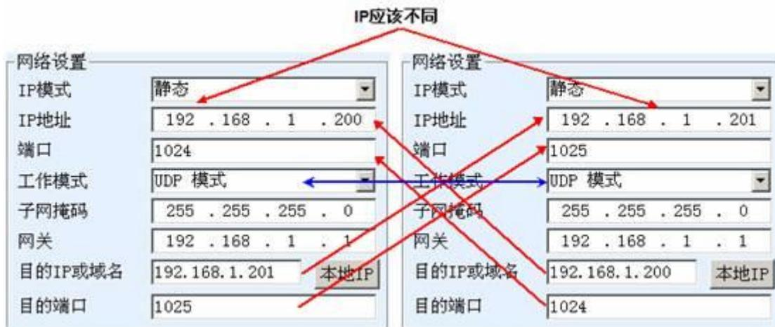
picture33 UDPDevice couplet parameter configuration
